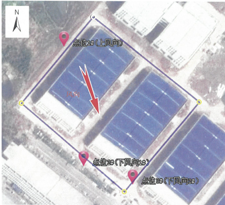
租赁轨道智谷工业园内 C5、C6 厂房厂界无组织废气监测点位图
