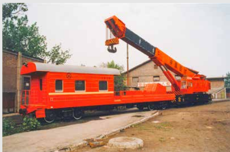
◎ N1004 型 100 吨全液压伸缩臂内燃起重 机
