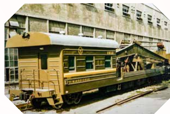
◎ N1002 型 100 吨固定臂铁路内燃起重 机
