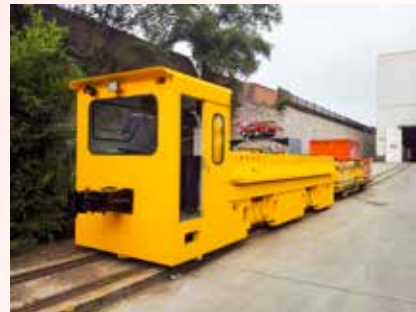
◎ CJB35-9GP 型直流架线式交流传动工矿机车
