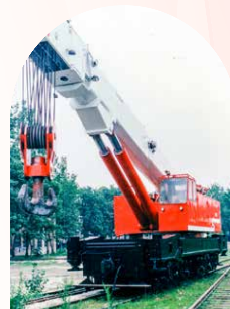
◎ NS1252 型 125 吨全液压伸缩臂 铁路起重机
