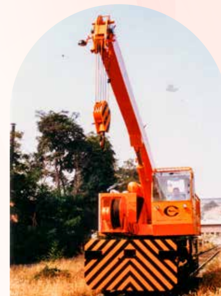
◎ RC-N1005-TZR 型 100 吨全液 压伸缩臂式铁路起重机
