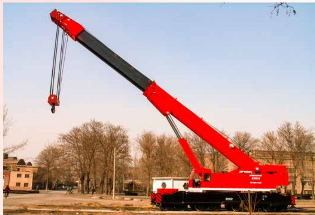
◎ NS160G 型 160 吨固定臂改伸缩臂铁路起重机
