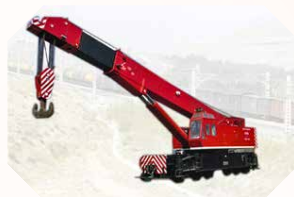
◎ NS100G 型固定臂改伸缩臂全液压铁路起重机
