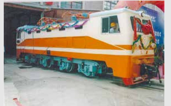
◎ ZK40 型交流变频架线式工矿电机车
