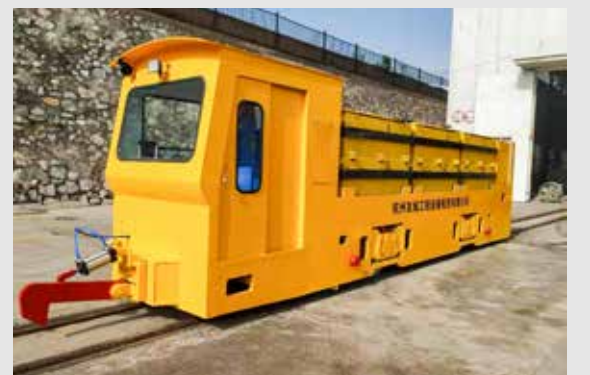
◎ XK55-9-540 型交流窄轨蓄电池工矿机车
