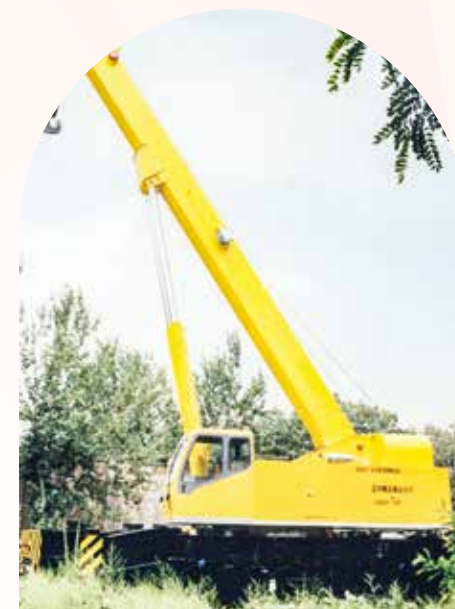
◎ NS0631 型 63 吨全液压铁路起重 重机
