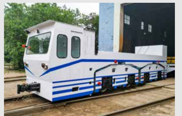
◎ XK45-14-540 型交流窄轨新能源电机车
