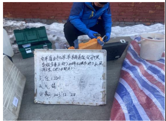
采样前洗井过程现场监测
