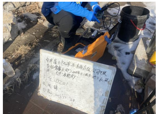
采样前洗井过程现场监测
