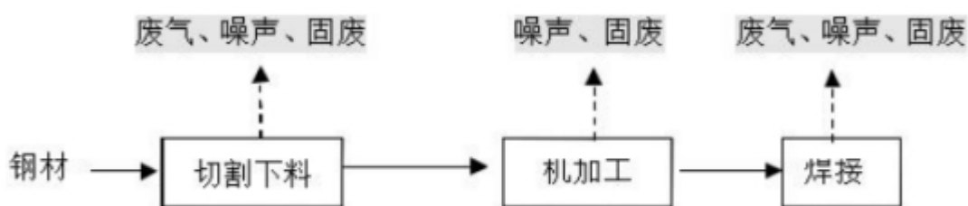
图 4-5 铆焊车间工艺流程及排污节点图
